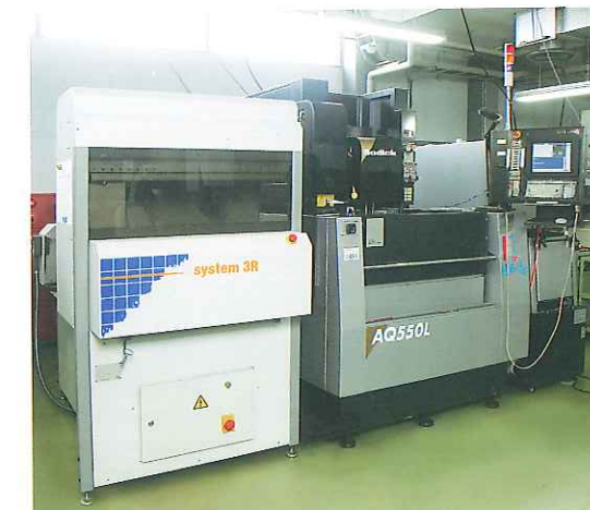
NCワイヤーカット放電加工機 NC wire cut electric discharge machine
